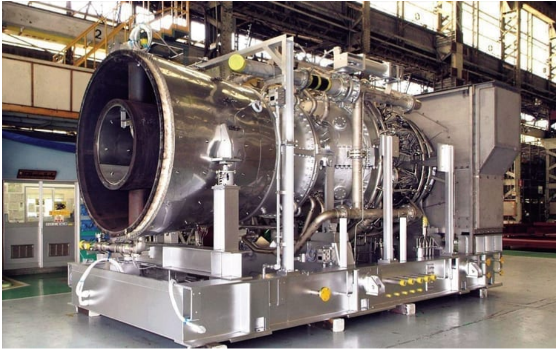
Abbildung 3.8. 40 MW H25 Mitsubishi 40 MW für den direkten Betrieb mit 100% Ammoniak.
