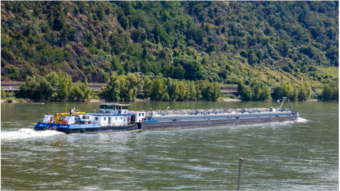
Abbildung 1.3. Schubschiff Thera mit dem Typ G Tankleichter Chemgas 23.
